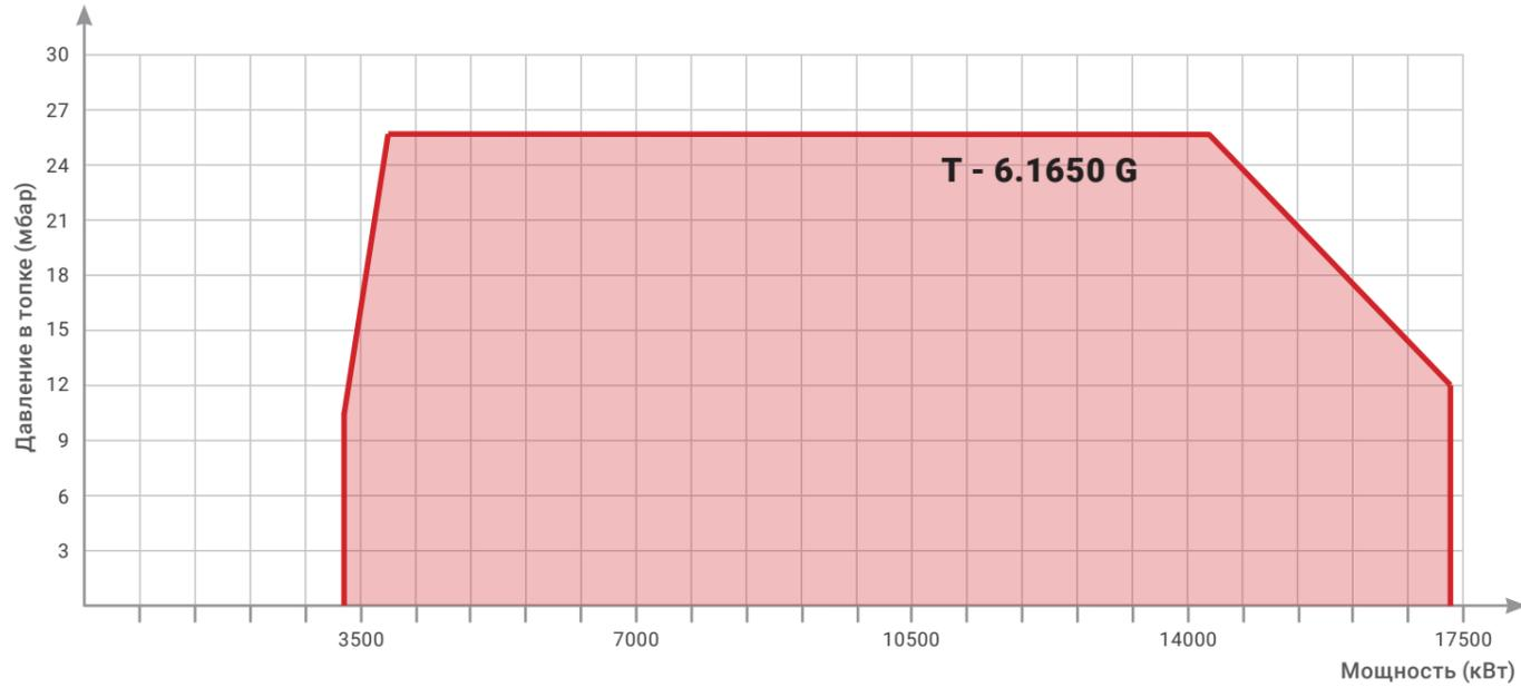
Условия испытаний согласно нормативам EN676. Температура - 20 °C; давление - 1013 мбар; высота - 0 м над уровнем моря.
